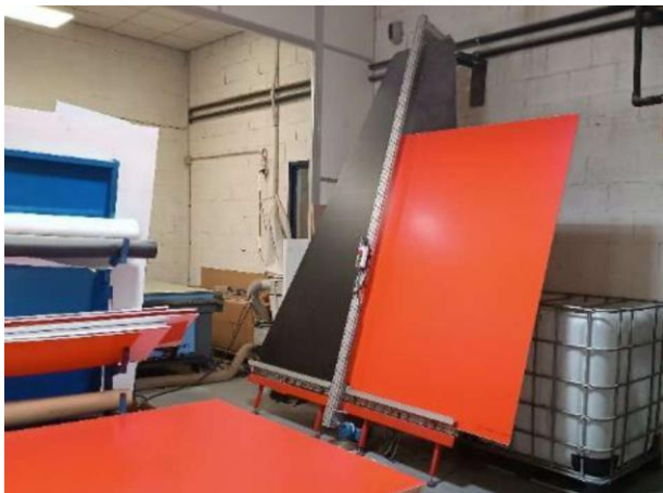
Sierra de corte vertical tablero, corte hasta 3000 mm
